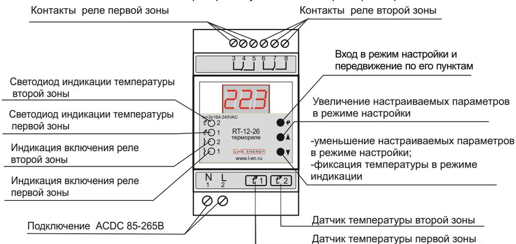
Рис 1. Внешний вид лицевых панелей RT-12-26 исполнение 22
