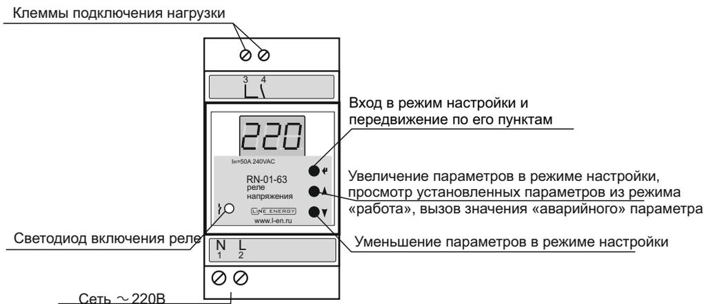
Рис 1. Устройство лицевой панели прибора
